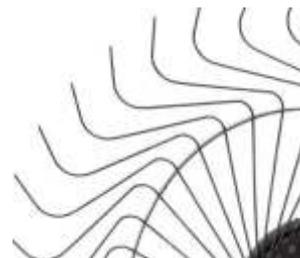
На граблях используется пружинный зуб диаметром 6,5 мм., на премиум версии используется зуб диаметром 7,0 мм.
