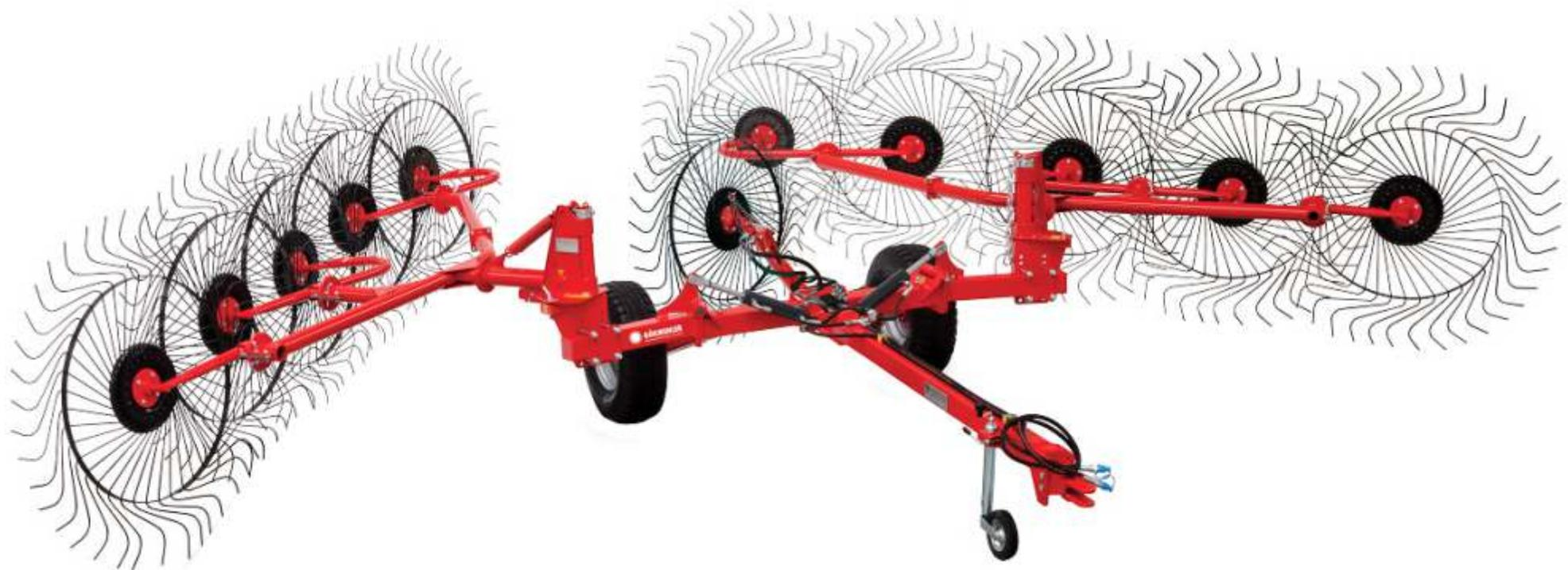
Г рабли колесно-пальцевые прицепные с центральным колесом модели GCR предназначены для сгребания подвяленной и сухой травяной массы из прокосов в валки заданной ширины, ворошения ее в прокосах, а также оборачивания валков, попавших под дождь за счет использования дополнительного центрального колеса.
