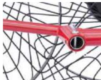
На граблях рамы между собой крепятся с помощью пальцев, на премиум версии используется фланцевое соединение.
