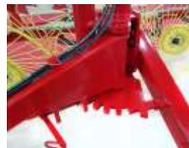
Возможность регулировки положения граблей при помощи поворотной рамы.
