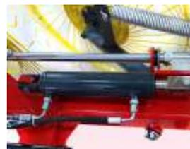
Грабли модели GSR имеют гидравлический цилиндр для поднятия колес в транспортное положение прямо из кабины трактора.
