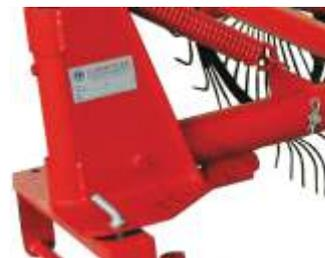
Грабли имеют лакокрасочное покрытие, плита поворотной пружинной стойки толщиной 7 мм; Отсутствует возможность регулировки пружин.
