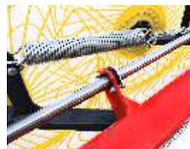
Каждое из колес имеет свою независимую пружину, которая позволяет граблям легко адаптироваться к любым контурам почвы.
