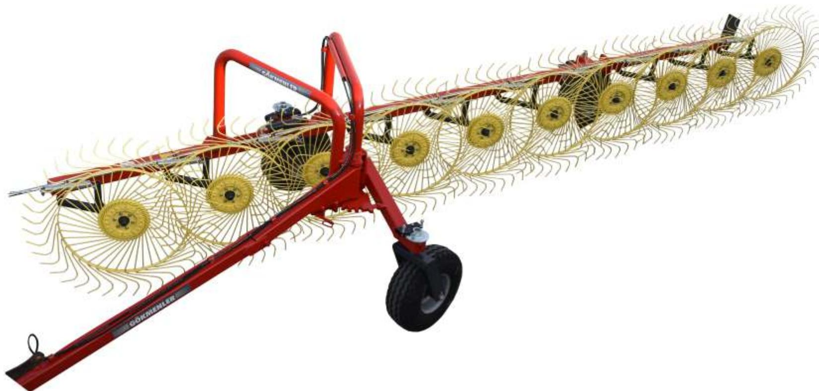
Грабли колесно-пальцевые линейные модели GSR – это быстрые, надежные и крепкие грабли. Они могут работать даже в трудных полевых условиях и с любым типом травы в результате всегда получается чистый, воздушный валок. При помощи линейных граблей, валки легко и быстро собираются вместе, чтобы сформировать один большой валок.
