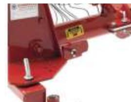
Плита поворотной пружинной стойки имеет толщину 8 мм. Грабли имеют полимерное покрытие.
