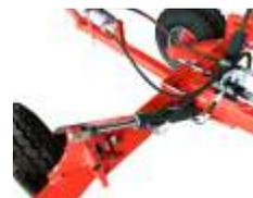
Грабли модели GCR имеют два мощных гидравлических цилиндра по бокам и дополнительный цилиндр на центральное колесо для поднятия граблей в транспортное положение прямо из кабины трактора.
