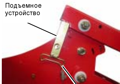
Пружина в позиции "верхнее положение"
