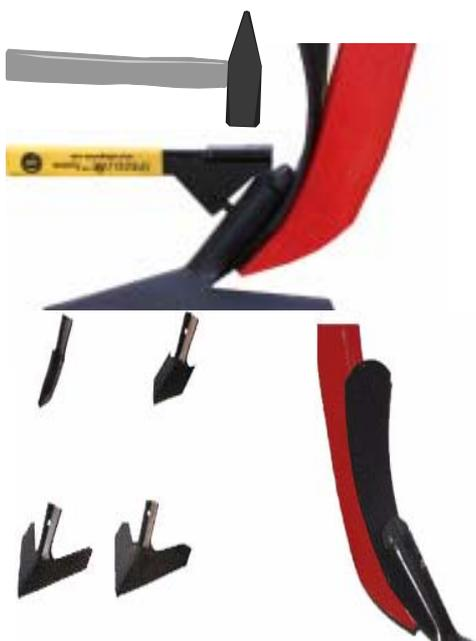
Система быстрой смены позволяет с помощью специального инструмента проводить простую замену лемехов. Для системы быстрой смены имеется ряд лемехов. Дополнительно лемехи могут оснащаться защитным щитком от соломы.
