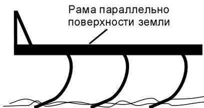
> Опустите машину в рабочее положение. Во время работы рама должна располагаться параллельно поверхности почвы.
