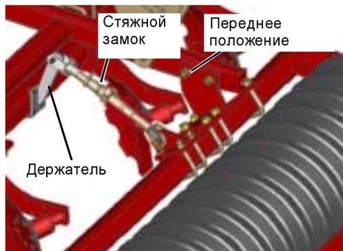
Крепление монтируется в зависимости от положения катка в другом положении.
