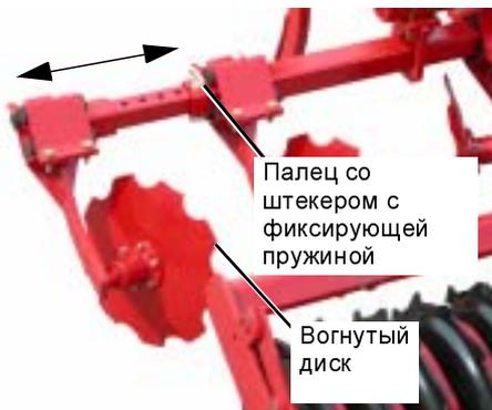
Оба наружных вогнутых диска могут согласовываться по рабочей ширине с особенностями почвы. Задачей является сохранение равномерной обработки по всей рабочей ширине. Неправильно отрегулированные машины оставляют за собой с наружной стороны соответственно земляной вал.
