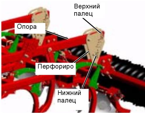
Рабочая глубина устанавливается на перфорированных плитах. Нижний палец определяет, как глубоко работает машина.
