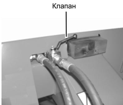
> Закройте механический предохранительный клапан.
