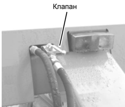
> Откройте механический предохранительный клапан.
