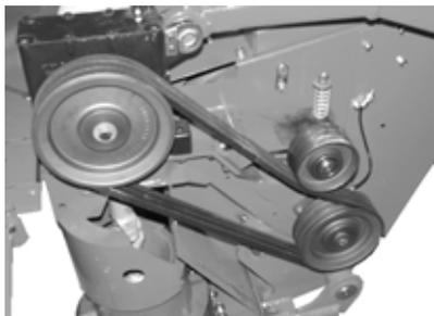
Машину можно оборудовать комплектом, состоящим из клиноременного шкива и трех клиновых ремней, для уменьшения числа оборотов ротора машины до 450 об/мин. Рекомендуется использовать это оборудование при уборке зерновых.
