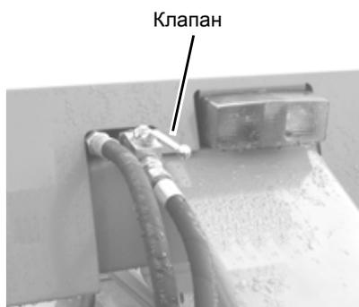
> Откройте механический предохранительный клапан.
