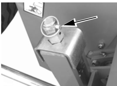
Машина имеет бесступенчатое регулирование высоты стерни. Высота стерни регулируется следующим образом:
