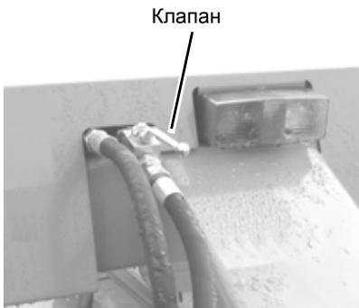
> Откройте механический предохранительный клапан.
