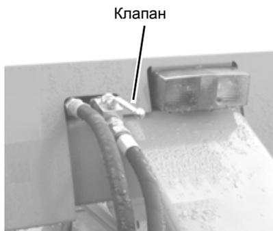
> Откройте механический предохранительный клапан.
