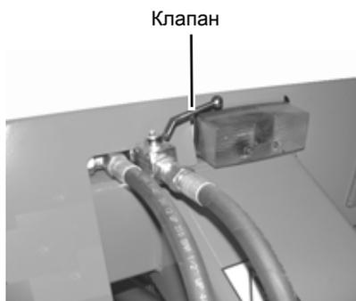
> Закройте механический предохранительный клапан.
