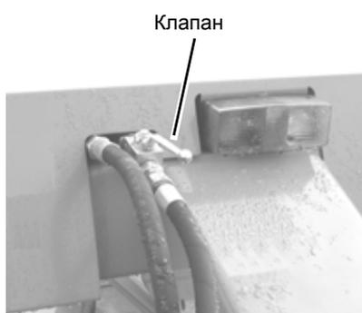
> Откройте механический предохранительный клапан.
