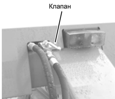
> Откройте механический предохранительный клапан.
