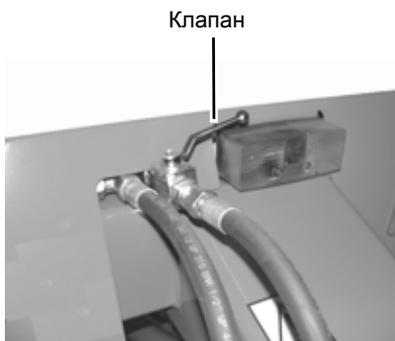
> Закройте механический предохранительный клапан.
