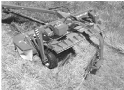
С помощью этой приставки можно сложить два валка в один. Это экономит время и повышает производительность при последующей обработке скошенной массы. Гибкость этого устройства позволяет также менять режимы с укладкой валков и без укладки, не тратя времени на перенастройку.
