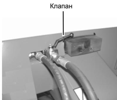
> Закройте механический предохранительный клапан.
