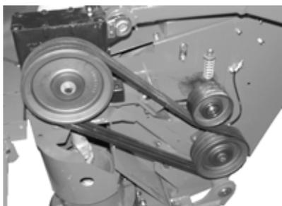
Машину можно оборудовать комплектом, состоящим из клиноременного шкива и трех клиновых ремней, для изменения числа оборотов ротора машины до 1015 об/мин. Рекомендуется использовать это оборудование при жатве трудных для уборки культур и/или при установке на машину приставки Вх.
