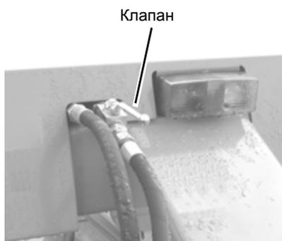
> Откройте механический предохранительный клапан.
