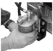
Произведите стравливание воздуха. См. Раздел 7.5. стр. 16. Запустите двигатель и проверьте отсутствие течей и парообразования от нового фильтра.
