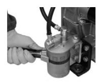
Снимите топливный фильтр с помощью специального инструмента.
