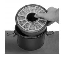
Залейте моторное масло до верхней отметки стакана фильтра.
