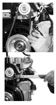
Затяните фиксирующий болт, с усилием 30 H/м для болтов с резьбой 8 х 1.25 и 50 H/м для болтов с резьбой 10 х 1.50.в 30 - 50 H/м.
