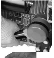
Снимите и замените масляный фильтр новым. Проверьте резиновое уплотнение на повреждение. Установите масляный фильтр. Затяните фильтр рукой.
