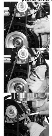
Также можно использовать измеритель натяжения генераторного ремня.
