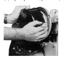
Откройте корпус фильтра и извлеките верхний фильтрующий элемент.
