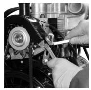
Открутите фиксирующие болты генератора.
