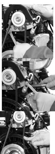
Отклоните генератор с необходимым усилием и затяните фиксирующий болт.
