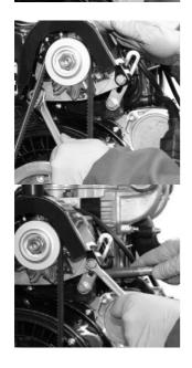
С усилием надавите не генератор в направлении от двигателя и затяните фиксирующий болт, с усилием 30 H/м для болтов с резьбой 8 х 1.25 и 50 H/м для болтов с резьбой 10 х 1.50.
